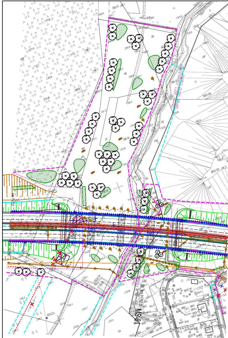
Rysunek 17. Zagospodarowanie przejścia dolnego MS-81 w km 7+870.00.
